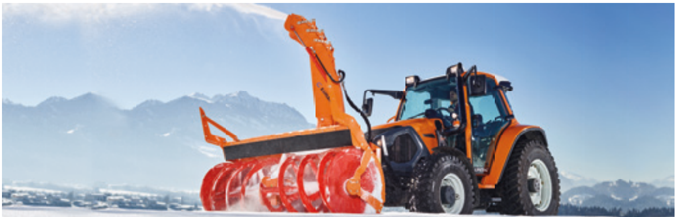
Die Heck-, Front- und Arbeitshydraulik mit Verstellpumpe machen den Lintrac zum variablen Geräteträger.
